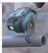
Corte de tubos de PVC
